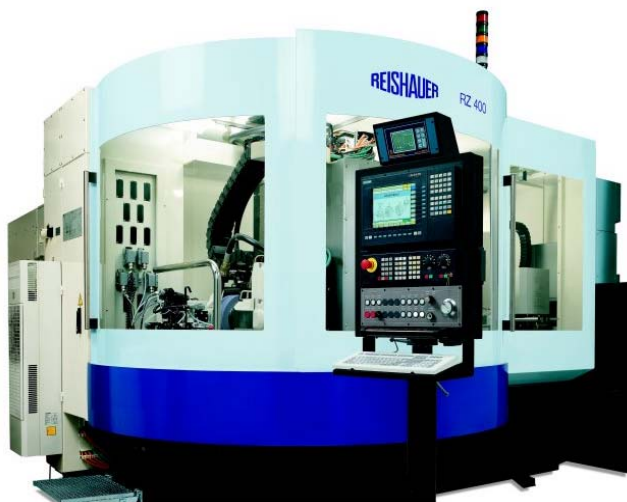
Bild 2: CNC-Verzahnungswälzschleifmaschine Reishauer RZ 400
