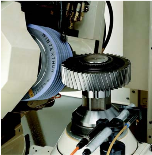
Bild 1: Hartfeinbearbeitung durch kontinuierliches Wäzschleifen
